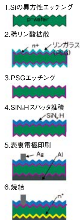
図1. 構築したBSF太陽電池製作ラインの製造工程
